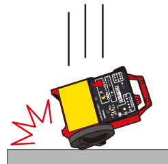
落下による故障
